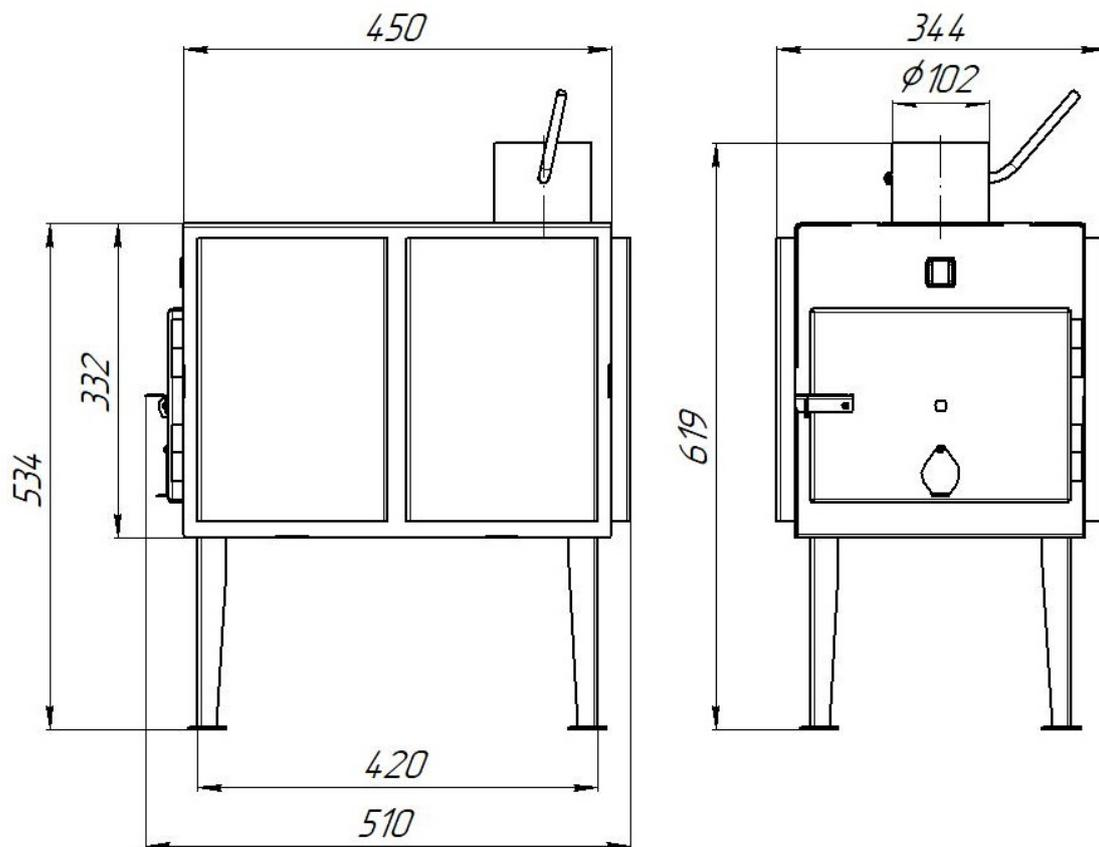
**Рисунок 1. Общий вид и габаритные размеры печи**
