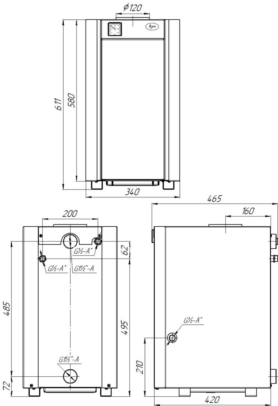
Рисунок 4. Внешний вид, габаритные и присоединительные размеры котла КСГ/КСГВ-12
