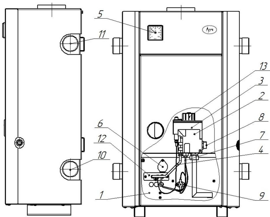
**Рисунок 2. Устройство котла КСГ-8С с автоматикой безопасности и регулирования SIT 630 или TGV 307**
